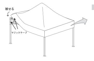
クロス桁の下側を通して固定します。
