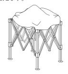
※天幕の中心部を確認し、被せます。ただし四隅には被せ ないで内側に天幕がくる様にして下さい。
