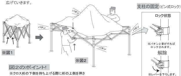
※クロス桁の下側を持ち上げる際に桁の上側を押さ えると広げやすくなります。
